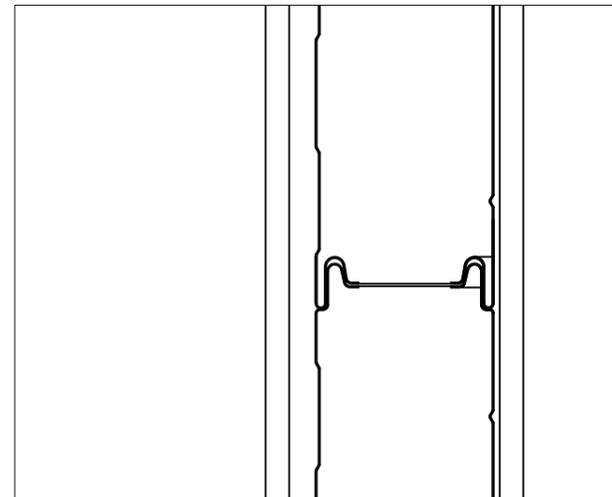
Detalle Junta de Paneles
